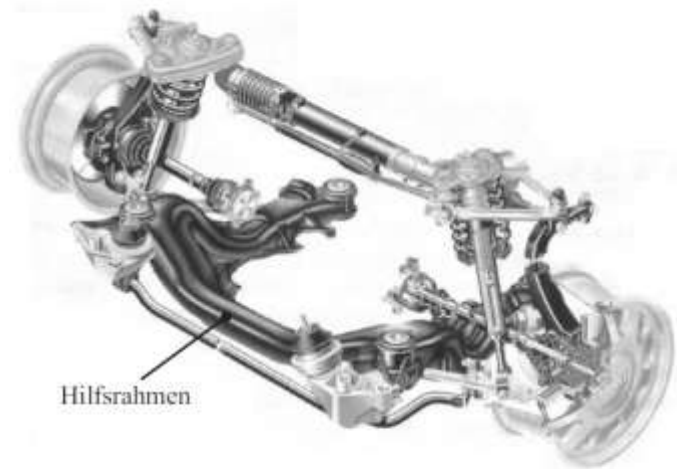
Bild 4.1: Motoraufhängung im Audi A6
